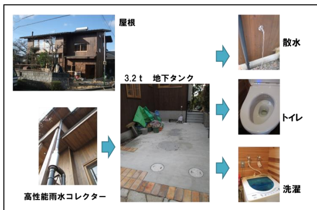
写真1 住宅での雨水利用システムの実例
